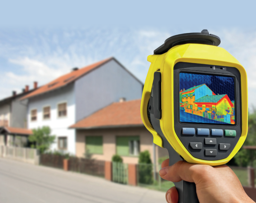
Fig. 2 : Mesure des pertes de chaleur par thermographie infrarouge. © PISÉO
